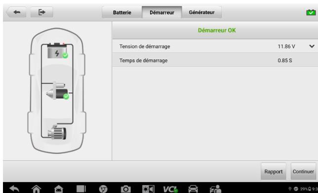
**Figure 6-10 Écran de Résultats du test de démarrage**
