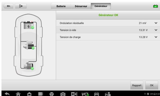
**Figure 6-12 Écran de Résultats du test de générateur**
